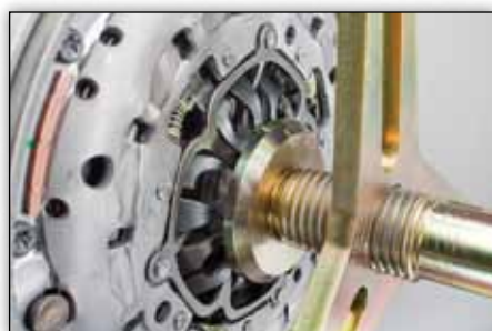
Fig. 8: Slăbiți fusul instrumentului SAC pentru a elibera arcul tip diafragmă și scoateți instrumentul folosind știfturile filetate
