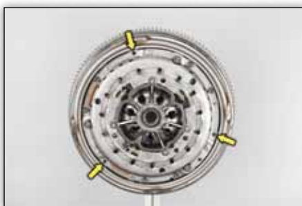
Fig. 9: Introduceți manual și celelalte trei șuruburi și strângeți-le cu o forță de 10,5 \pm 1 Nm
