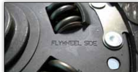
Снимка 4: Неправилен монтаж
