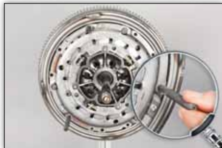
Снимка 5: Завъртете на ръка шпилките на инструмента SAC, докато усетите леко съпротивление. не използвайте инструмент
