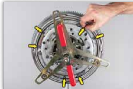
Снимка 7: Вмъкнете в 6-те достъпни резби доставените болтове на ръка, след което ги затегнете до 10,5 \pm 1 Nm
