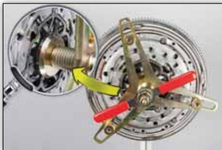
Снимка 6: Сглобете инструмента SAC и предварително натегнете притискателния диск, докато покриващият фланец легне на маховика DMF на LuK.
