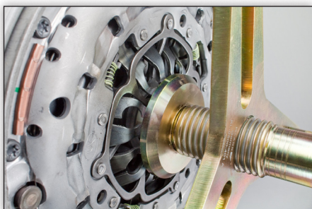
Obrázek 8: Povolením centrálního šroubu SAC nářadí uvolníte talířovou pružinu a SAC nářadí potom demontujte vč. svorníků.
