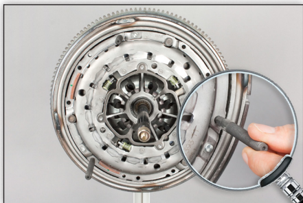
Obrázek 5: Svorníky SAC-nářadí zašroubujte rukou až do zjištění prvního odporu, nepoužívejte žádné nářadí.
