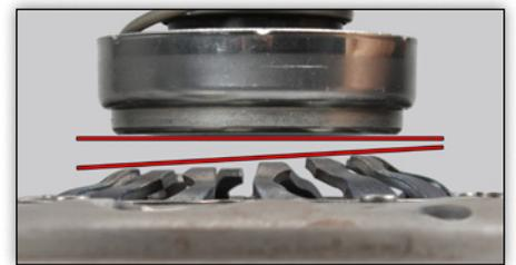
**Bild 4:** falscher Einbau
