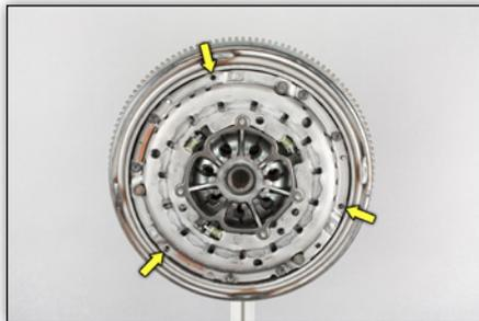
**Bild 9:** Restliche 3 Schrauben von Hand eindrehen und mit 10,5±1 Nm festziehen
