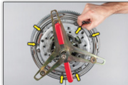
Εικόνα 7: Βιδώστε χειροκίνητα τις βίδες του σετ στα 6 διαθέσιμα σπειρώματα και σφίξτε με ροπή σύσφιξης 10.5±1 Nm
