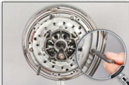
Εικόνα 5: Χειροκίνητα βιδώστε τα μπουζόνια στο εργαλείο SAC μέχρι να νοιώσετε ελαφριά αντίσταση. ΜΗΝ χρησιμοποιήσετε εργαλείο
