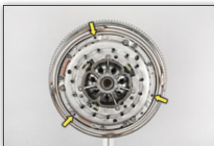
Εικόνα 9: Βιδώστε τις τρεις εναπομένοντες βίδες με το χέρι και σφίξτε με ροπή 10.5±1 Nm
