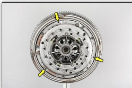
**Fig. 9:** Atornillar a mano los 3 tornillos restantes y apretarlos a  $10,5 \pm 1$  Nm
