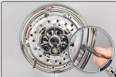
**Fig. 5:** Atornillar a mano el espárrago de la herramienta SAC hasta percibir una primera resistencia, no utilizar ninguna herramienta.
