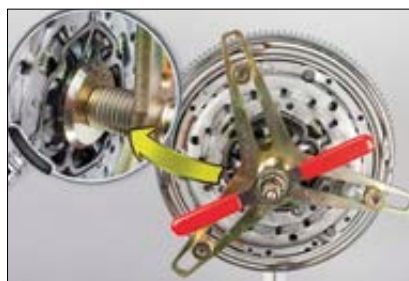
Kuva 6: Asenna SAC-työkalu ja esijännitä kytkimen painelevy niin, että painelevy osuu kiinnitysalueella vauhtipyörään.
