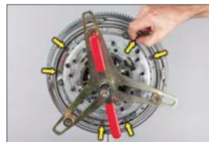
Kuva 7: Kierrä toimituksessa olevat ruuvit käsin 6 vapaaseen kierrereikään ja kiristä ne 10,5±1 Nm kiristysmomentilla.
