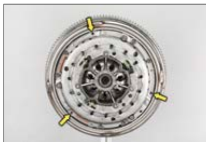
Kuva 9: Kierrä loput 3 ruuvia paikalleen käsin ja kiristä ne sitten 10,5±1 Nm momentilla.
