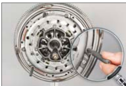
Kuva 5: Kierrä SAC-työkalun pultit käsin siihen saakka, kunnes tunnet vastusta, älä käytä mitään työkalua.
