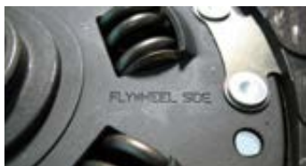
איור 4: התקנה לא נכונה
