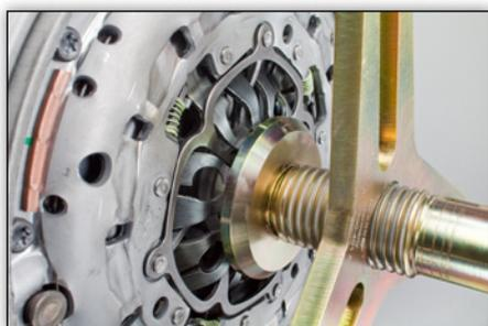
**Figura 8:** Allentando il mandrino portautensile SAC distendere la molla e rimuovere l'utensile con il perno
