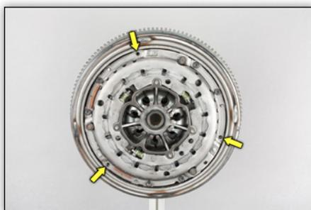
**Figura 9:** Avvitare manualmente le 3 viti restanti e serrarle a  $10,5 \pm 1$  Nm
