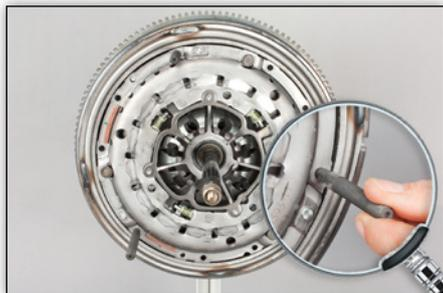
**Figura 5:** Avvitare manualmente il perno dell'utensile SAC fino a percepire la prima resistenza, non impiegare alcun attrezzo
