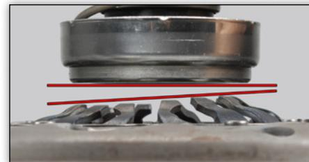
**Figura 4:** Montaggio errato
