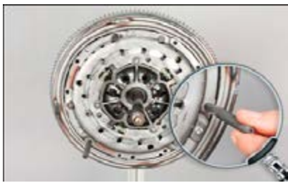
Рис. 5: Поместите корзину сцепления поверх маховика (следите за центрирующими штифтами). Не затягивайте болты нажимного диска сцепления!
