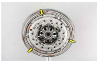
Рис. 9: Вытащите центрирующую вставку, затяните болт и затяните винты нажимного диска в остальных отверстиях (винты на 3/4 дюйма) усилием в 10.5 \pm 1 Нм.
