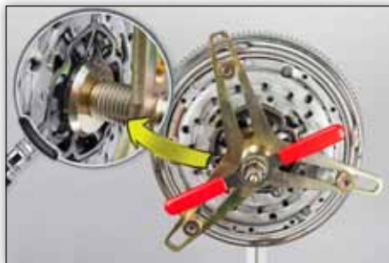
Bild 6: Montera SAC-verktyget och förspänn tryckplattan, så att den ligger an i området för fastsättning på dubbelmassesvänghjulet.
