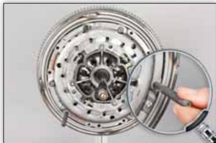
Bild 5: Dra in SAC-verktygets pinnskruvar för hand till dess det tar emot. Använd inte verktyg.
