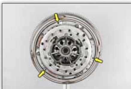
Bild 9: Dra därefter in de tre resterande skruvarna för hand och dra därefter åt dem med åtdragsmomentet 10,5±1 Nm.
