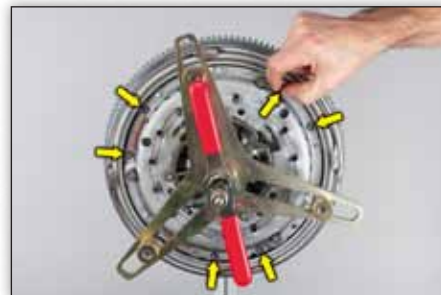
Bild 7: Dra in de medlevererade skruvarna i de sex fria hålen för hand och dra därefter åt med åtdragsmoment 10,5±1 Nm.
