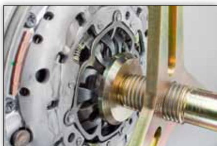
Bild 8: Lossa SAC-verktygets centralskruv varvid tallriksfjädersn. Ta därefter bort SAC-verktyget inkl. pinnskruvarna.
