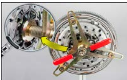
Рис. 6: Затем вращайте нажимное устройство до тех пор, пока диафрагменная пружина не вдавится полностью.
