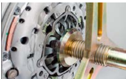
Рис. 8: Потом вращайте нажимное устройство в противоположном направлении, чтобы снять нагрузку с диафрагменной пружины, открутите винты с накаткой и снимите нажимное устройство.
