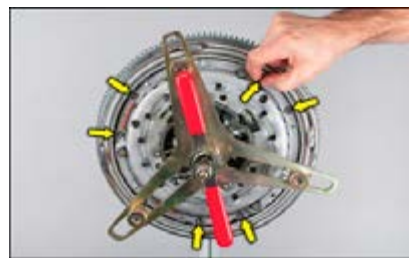
Рис. 7: При вдавленной диафрагменной пружине, вкрутите и затяните в свободные отверстия винты нажимного диска сцепления усилием в 10.5 \pm 1 Нм.
