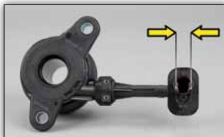
Fig. 1: Conexiune hidrolică LuK CSC 510 0090 10 de 12,2 mm
