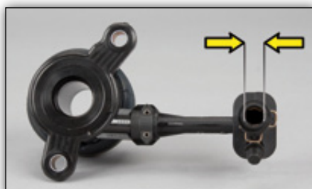
Εικόνα 3: Υδραυλικός σύνδεσμος 11.7 mm για το LuK CSC 510 0098 10
