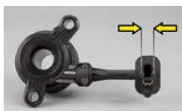
איור 2: חיבור הידראולי של משאבה משנית כוללת מיסב מק"ט- 10 510 0097 בקוטר 13.3 מ"מ
