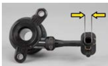
איור 3: חיבור הידראולי של משאבה משנית כוללת מיסב מק"ט- 10 510 0098 בקוטר 11.7 מ"מ
