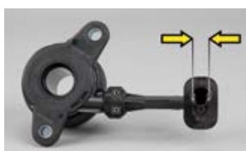
איור 1: חיבור משאבה משנית כוללת מיסב (CVC) מק"ט- 10 510 0090 בקוטר 12.2 מ"מ
