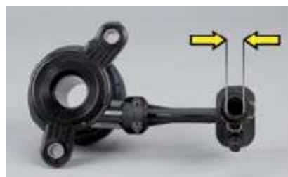
Рис. 3: LuK CSC 510 0098 10 с гидравлической муфтой 11.7 мм.
