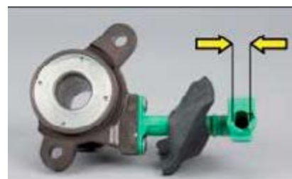
Рис. 2: LuK CSC 510 0137 10 с гидравлической муфтой 12.2 мм.
