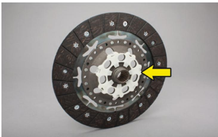
Figura 1: disco de embraiagem com anel de plástico
