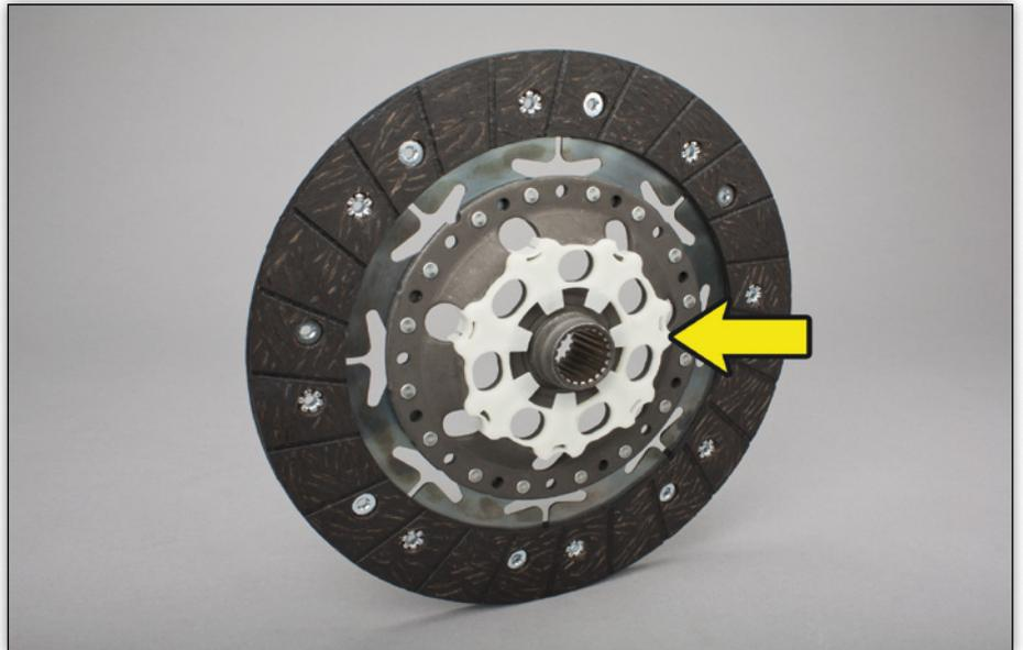
**Bild 1:** LuK Kupplungsscheibe mit Kunststoffring
