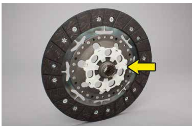
Εικόνα 1: Δίσκος συμπλέκτη με πλαστικό δακτυλίδι
