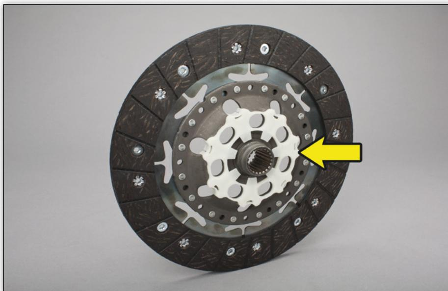
**Photo 1:** LuK disque d'embrayage équipé de la bague en plastique
