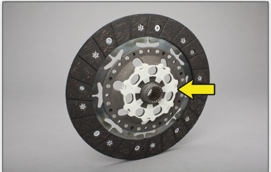
**Figura 1:** Disco frizione con anello in plastica
