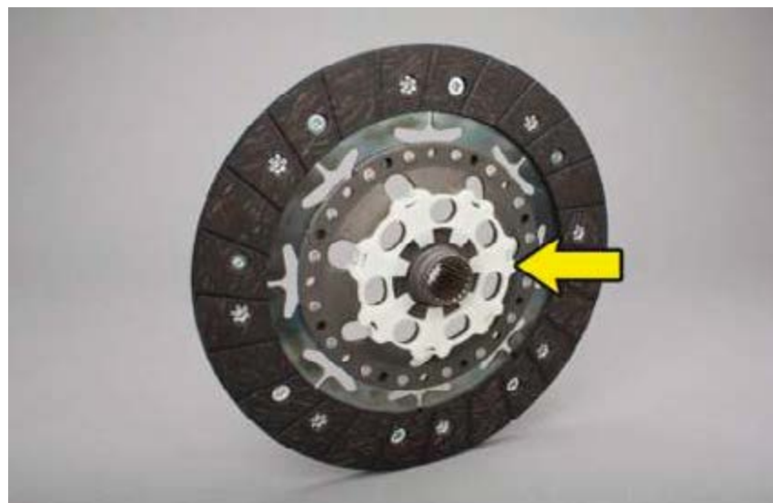
Рис. 1: Ведомый диск сцепления с пластиковым кольцом
