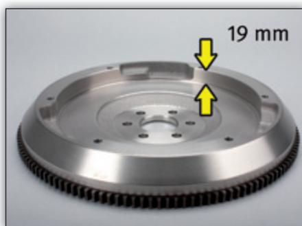
**Fig. 1:** Nº OE 90536140 / 616169 sem afundamento do contorno, profundidade do volante motor 19 mm
