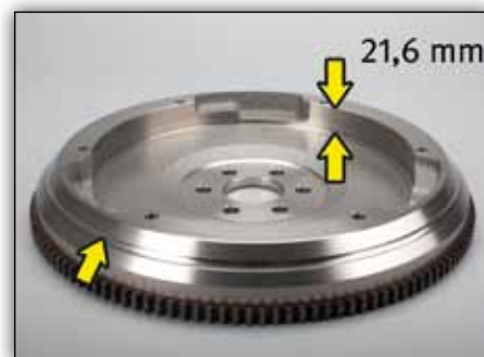
Снимка 2: OE номер 93186460/5616016 с отстъп по периферията, дълбочина на маховика 21,6 mm
