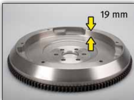
Снимка 1: OE номер 90536140/616169 без отстъп по периферията, дълбочина на маховика 19 mm
