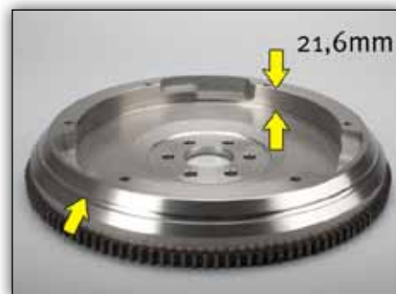
Obrázek 2: OE-č. 93186460 / 5616016 s prohloubením na obvodu, hloubka setrvačnicku 21,6 mm
