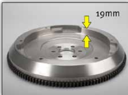
Figur 1: OE-nr. 90536140/616169 uden hulning i periferi; svinghjulets dybde: 19 mm
