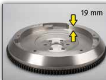
Εικόνα 1: Κωδικός OE: 90536140/616169 χωρίς εσοχή γύρω από την περιφέρεια, βάθος βολάν 19mm
