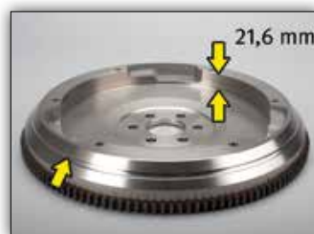
Εικόνα 2: Κωδικός OE: 93186460/5616016 με εσοχή γύρω από την περιφέρεια, βάθος βολάν 21.6mm
