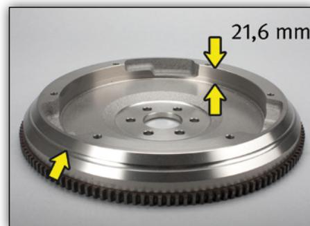
**Figura 2:** Nº OE 93186460 / 5616016 con ahondamiento del contorno, profundidad del volante motor 21,6 mm
