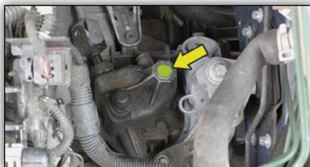
**Figura 3:** marca en la caja de cambios
