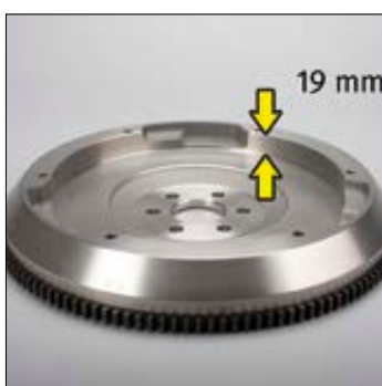
Kuva 1: OE-nro 90536140/616169 ilman syvennystä kehällä, vauhtipyörän syvyys 19 mm
