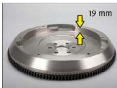
Рис. 1: OE № 90536140 / 616169 без выемки по окружности, глубина маховика 19 мм.
