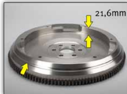
Bild 2: OE-nr. 93186460/5616016 med fördjupning på periferin, djup hos svänghjul 21,6 mm
