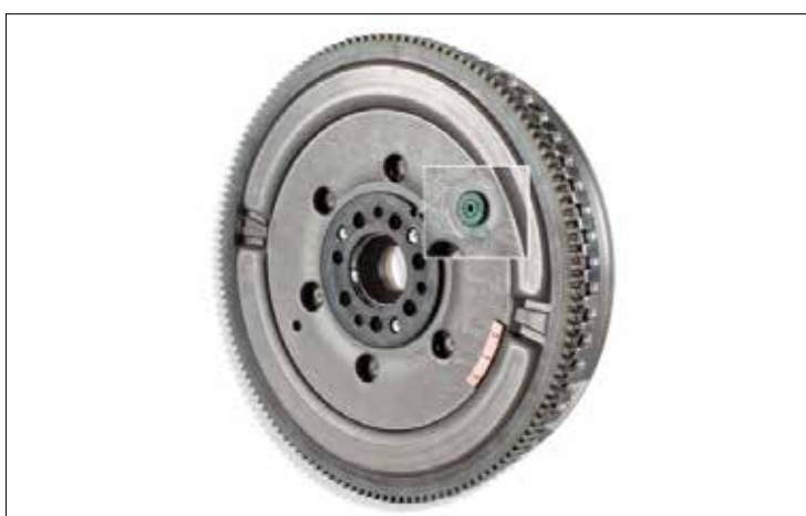
Εικόνα 1: ΒΔΜ LuK με πείρο συγκράτησης όπως και ασφάλεια μεταφοράς
