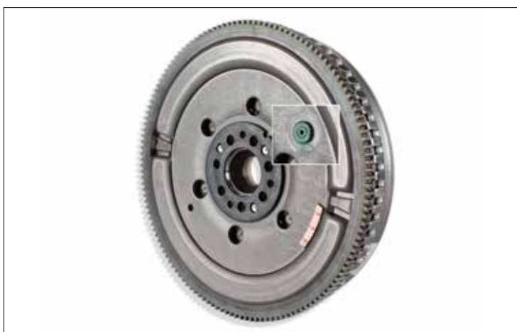
Bild 1: Dubbelmassesvängghjul från LuK med låssprint som transportsäkring
