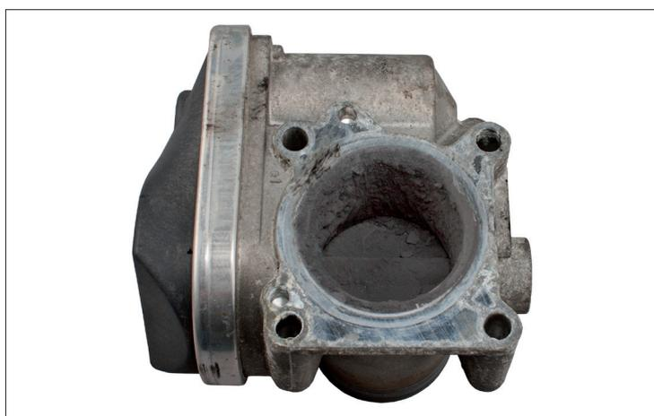
Bild 1: Verunreinigungen im Drosselklappenteil sind zu entfernen
