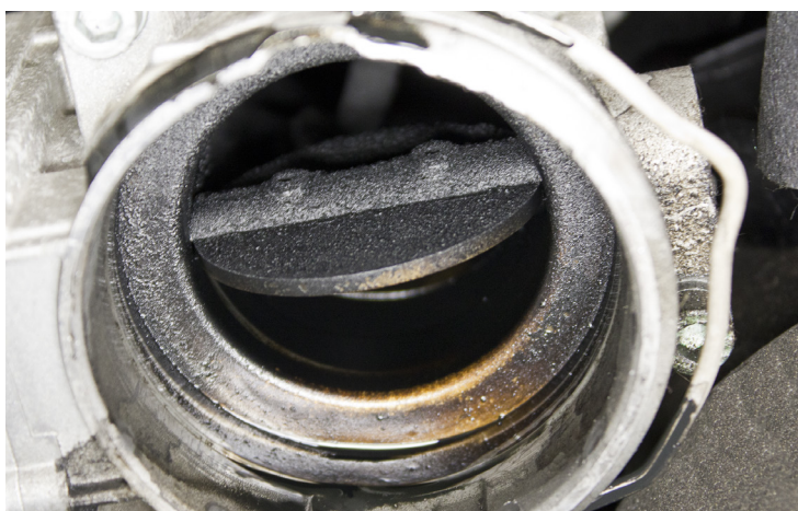
Bild 1: Borttagning av föroreningar i delarna till strypspjället
