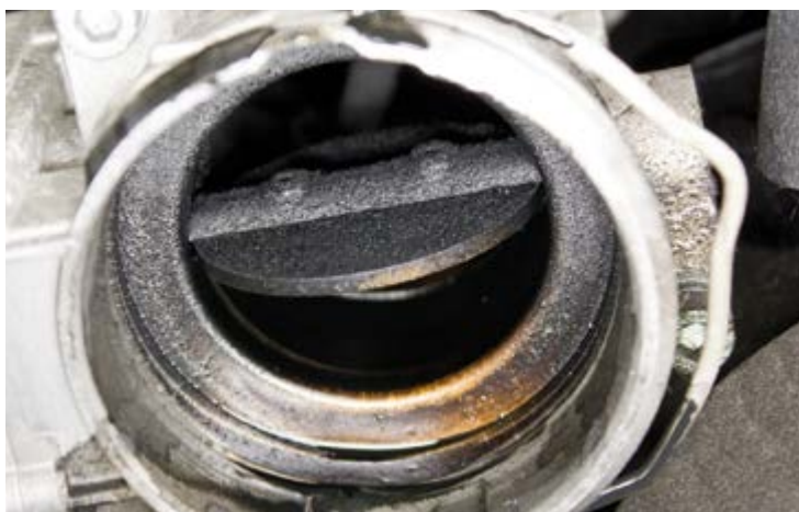
Рис. 1: Любая грязь из корпуса дросселей должна быть удалена.
