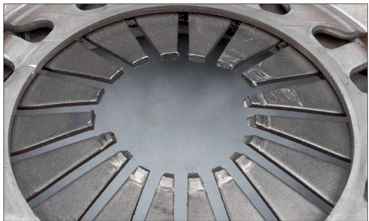
Bild 1: Defekte Tellerfeder durch fehlende Vorlast
