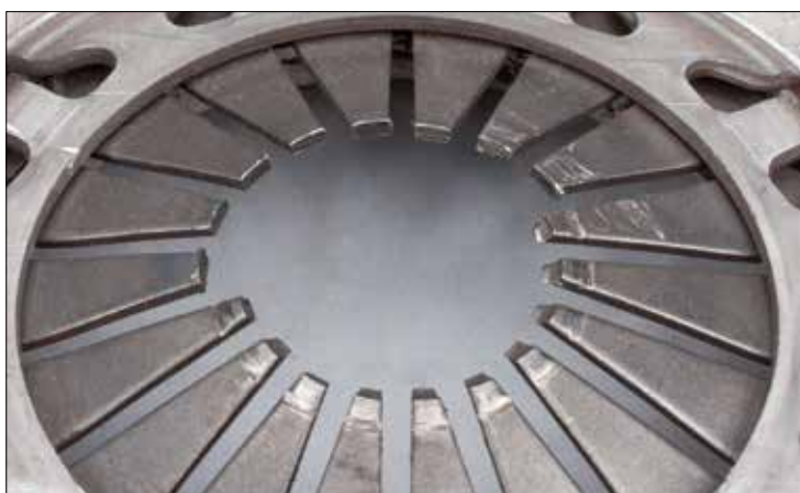
Figur 1: Defekt membranfjær forårsaket av manglende forbelastning
