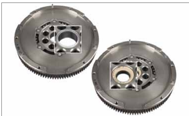
Εικόνα 1: Σύγκριση του BDM 415 0388 10 με κουζινέτο (αριστερά) και ρουλεμάν (δεξιά)
