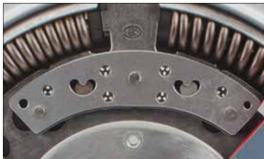
Fig. 2: Pendul pentru reducerea forței centrifuge
