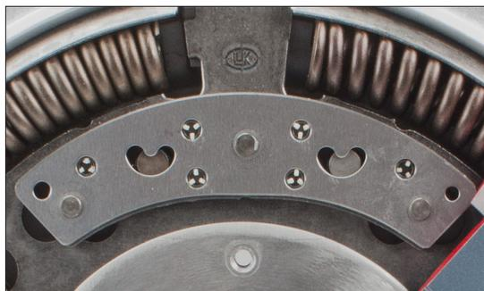
Fig. 2: Péndulo centrífugo
