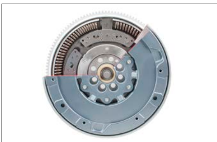
Kuva 1: Keskipakoisheilurilla varustettu kaksoismassavauhtipyörä leikkauskuvassa
