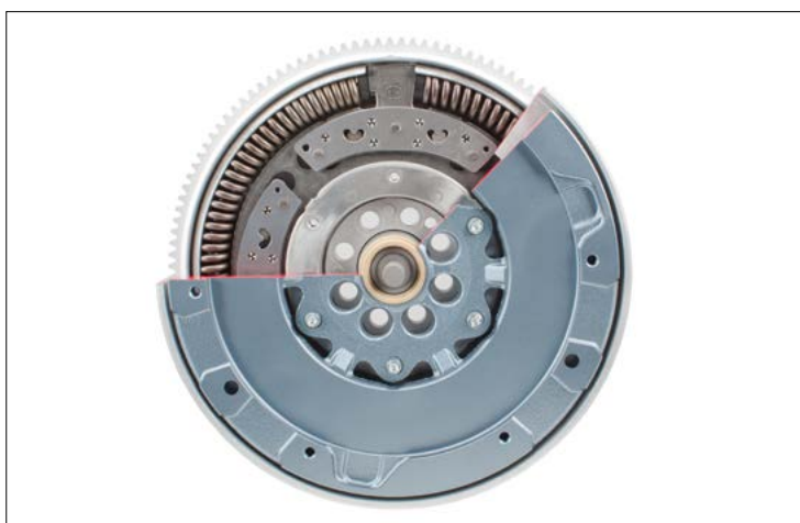
1. ábra: Kettős tömegű lendkerék röpsúlyos ingával metszetben
