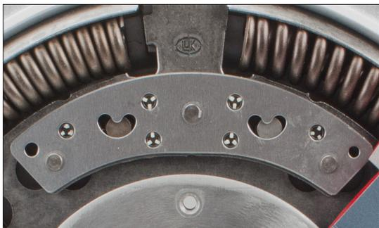
Figura 2: Pendolo centrifugo
