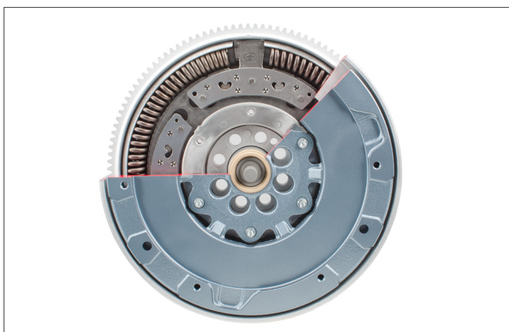
Bild 1: Dubbelmassesvänghjul med centrifugalpendel i genomskärning
