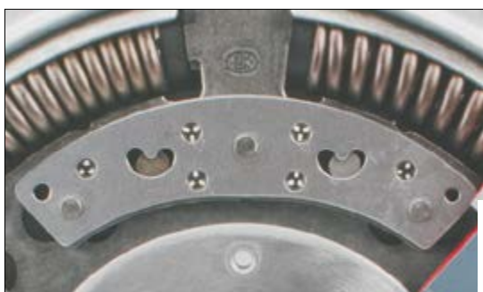
Рис. 2: Центробежный демпфер маятникового типа.
