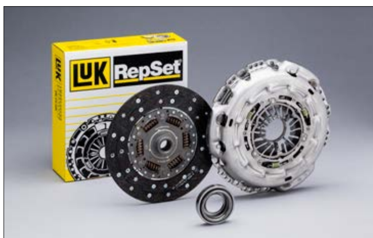
Рисунок 1: Комплект LuK RepSet® 626 3077 00 с саморегулирующимся сцеплением
