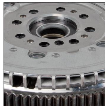
Figura 2: nuova versione dell'anello del sensore
