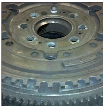
Figura 1: versione precedente dell'anello del sensore
