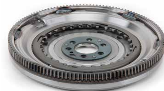
Obrázek 1: Počet zubů na věnci startéru u nového dílu musí být totožný s počtem zubů starého dílu
