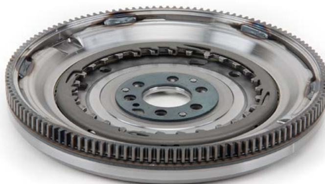
Pilt 1: Uue ja vana hooratta hammasvöö hammaste arv peab olema sama
